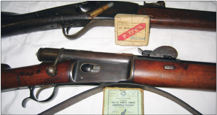
Peabody (oben) und Vetterli M1878 sind zwei Ordonanzwaffen, die für die Jagd abgeändert wurden.
